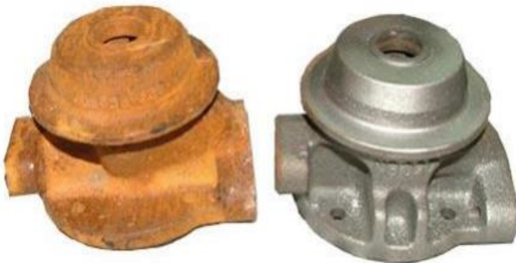
Figura 2: Peça metálica antes e depois do tratamento de jateamento Fonte: Paredes (2017)
