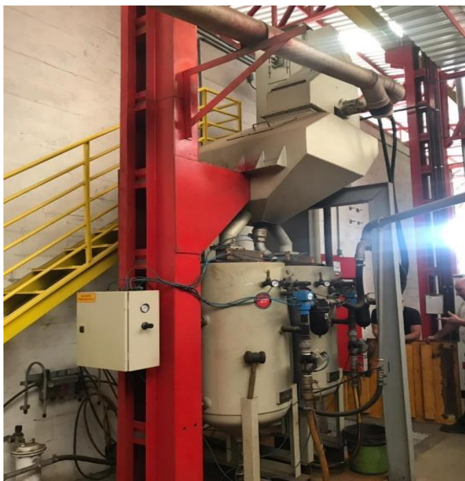
Figura 8: Garrafa de captação da granalha empresa B Fonte: O autor (2018)
