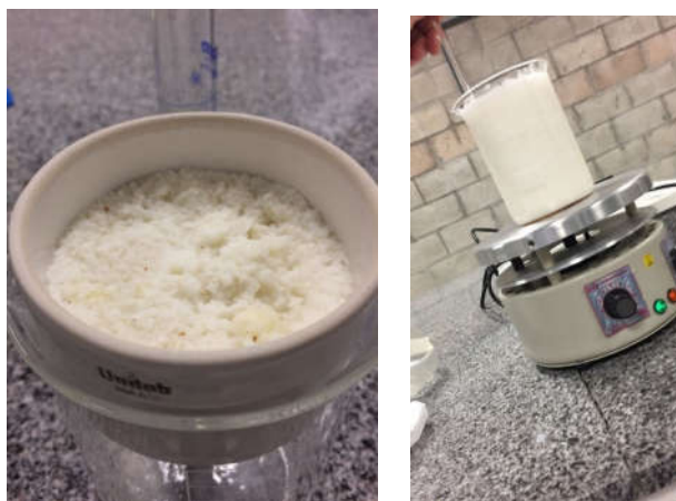
Figura 2: Filtragem da mistura amido + água e aquecimento da mistura. Fonte: Próprio autor.
