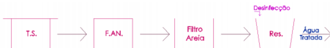
Figura 1 – Sistema de tratamento de águas cinzas
