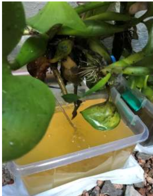
Figura 2: Instalação do sistema Wetlands e aplicação dos aguapés no recipiente contendo efluente. Fonte: Autoral.
